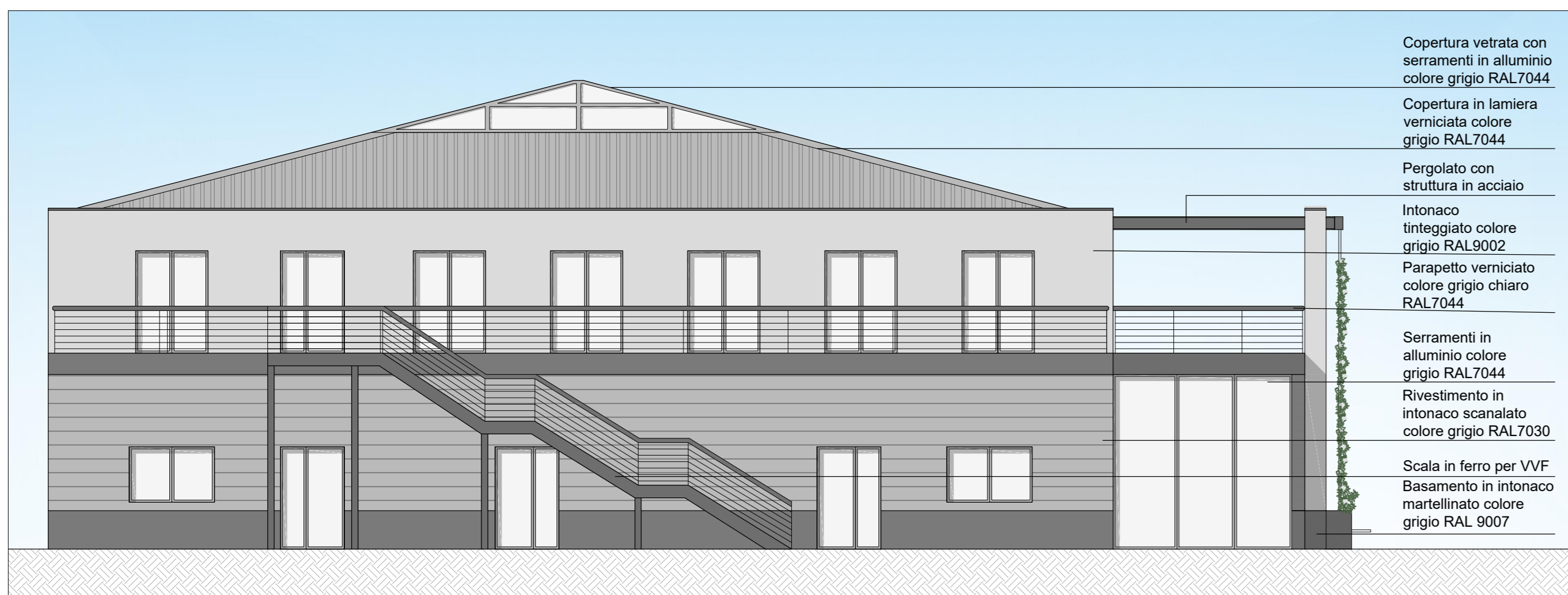
PROSPETTO SUD - STATO DI PROGETTO - SCALA 1:100
