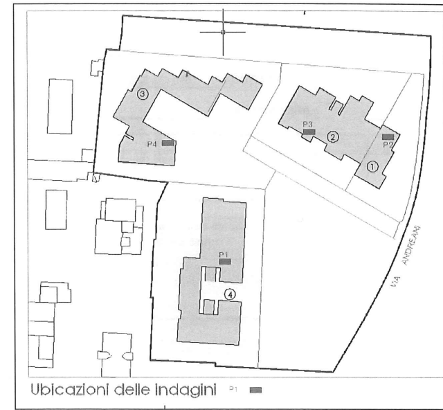
Figura 13: Planimetria con l'ubicazione dei pozzetti esplorativi realizzati
