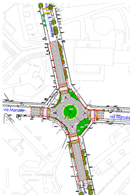
Schema delle opere viabilistiche in progetto all'intersezione tra via Marsala e via Kennedy.
