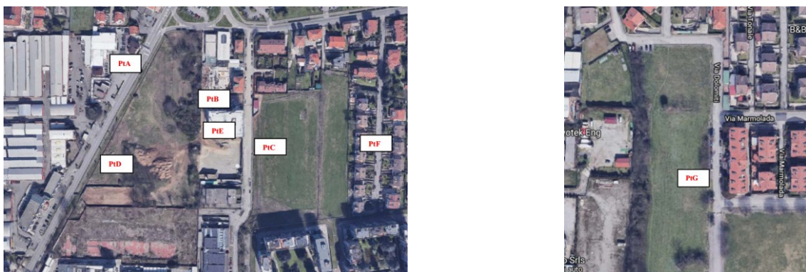
Localizzazione dei punti di misura dei rilievi fonometrici per la caratterizzazione del clima acustico.
