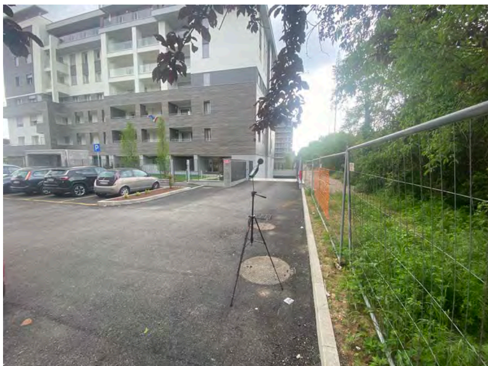
Foto 2: Fonometro posto in PointB, nel nuovo parcheggio in prossimità dell'edificio R1 già realizzato.
